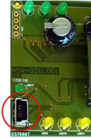
Das SFW-8 verfügt über eine USB-Schnittstelle (Mini-USB), über die die Parametrierung des Gerätes möglich ist. Zur Gewährleistung der korrekten Funktion muss vor der ersten Benutzung die USB-Treiberdatei „lpc\_driver\_setup.exe“ installiert werden (Datei ist auf dem im Lieferumfang enthaltenen Installationsmedium zu finden). Unterstützt werden Windows-PCs ab Windows XP.
