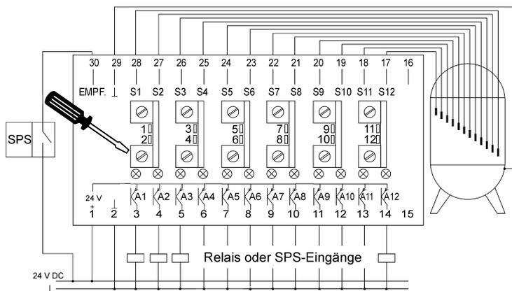
Die Ausgänge sind PNP-OPEN-COLLECTOR – Transistoren. Diese sind durch eine gemeinsame Stromquelle gegen Kurzschluss geschützt (maximaler Gesamtstrom: 150 mA).
