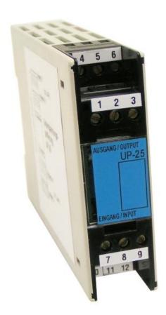
Das UP-25 dient zur kurzzeitigen Versorgung von Gleichspannungsgeräten, die empfindlich auf Spannungseinbrüche reagieren, wie zum Beispiel Regler oder CPUs von Speicherprogrammierbaren Steuerungen. Es überbrückt Spannungseinbrüche (keine Unterbrechung), die z.B. beim Starten von Dieselaggregaten auftreten und stellt den angeschlossenen Steuerungen für die Überbrückungszeit die notwendige Versorgungsspannung zur Verfügung.
