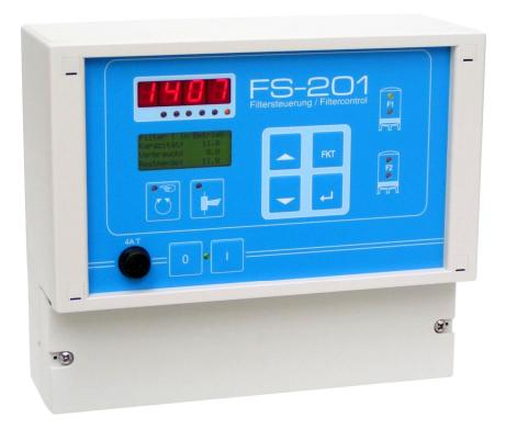
Die Filtersteuerung FS-201 dient der Steuerung einer Ein- oder Zweifilteranlage mit Pilotverteilern oder Zentralsteuerventilen. Die Ventiltypen werden über die Konfiguration ausgewählt und die FS-201 passt sich im Funktionsablauf automatisch dem gewählten Ventiltyp an. Es können sowohl Entkarbonisierungsfilter als auch Kiesfilter gesteuert werden.
