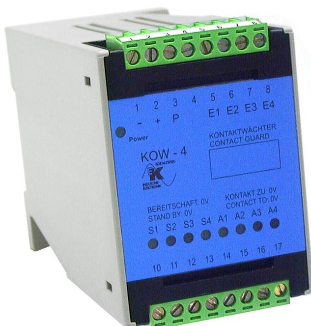
Das KOW-4 kann 4 unabhängige Kontakte auf ihren Schaltzustand überprüfen sowie Kabelbruch und Kurzschluss erkennen. Die verschiedenen Konfigurationen des KOW-4 unterscheiden sich hinsichtlich der Gruppierungen ihrer Störungsausgänge S1 bis S4 und werden durch unterschiedliche Steckbrückenbelegungen (J1, J2 und J3) realisiert.
