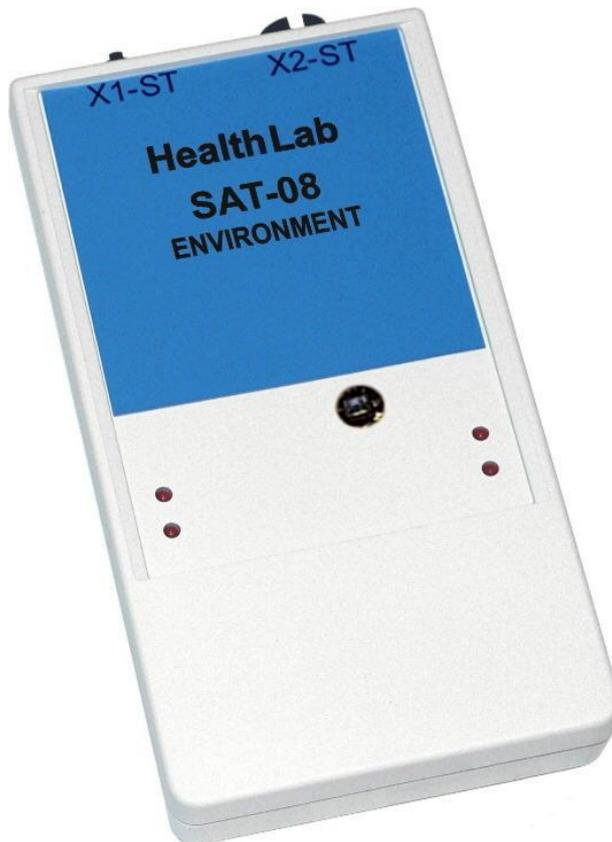
Der HealthLab Mess-Satellit SAT-08 ist ein Messmodul des psychophysiologischen Monitoring-Systems HealthLab. Im Rahmen von Messungen mit HealthLab erfasst der Satellit SAT-08 das Mikroklima in unmittelbarer Nähe zum Probanden. Es werden die Lufttemperatur, die Luftfeuchtigkeit und der Luftdruck gemessen.
