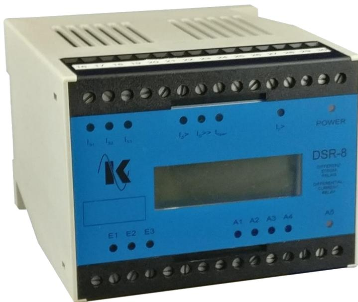
Das DSR-8 ist ein Gerät zur Differenzstrommessung an Generatoren, Motoren und Transformatoren. Die Überwachung von Mischformen wie z.B. einem Generator mit vorgeschaltetem Blocktransformator ist ebenfalls möglich. Zusätzlich zum Differenzstrom ist die Messung der einzelnen Leiterströme, sowie des Erdstromes in Dreileiter-Netzen möglich. Der Anschluss an die Anlage muss über externe Stromwandler erfolgen.
